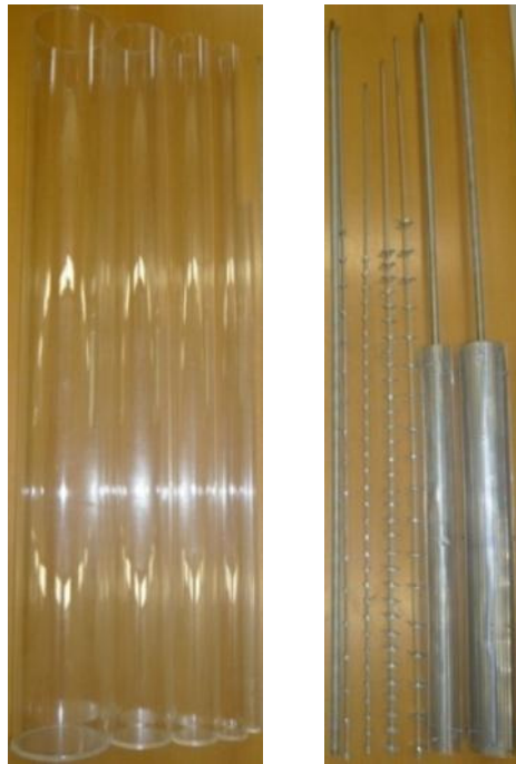
Abbildung 5.4: Versuchsreihe 1 – verwendete Hüllrohre und untersuchte Dämpfer
