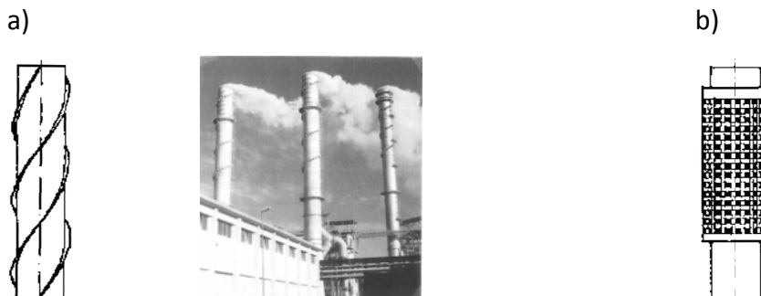
Abbildung 3.13: Systeme zur Abwehr windinduzierter Schwingungen. Aerodynamische Störelemente. a) SCRUTON-Wendel und b) PRICE-Shroud (PETERSEN, 2001)
