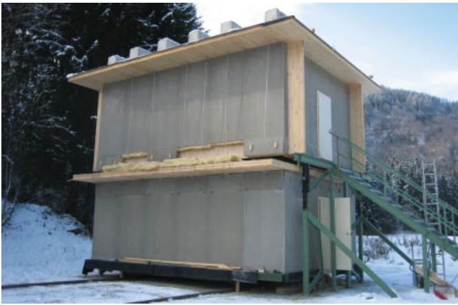
Bild 8. Mit Betonelementen, Gesamtgewicht 240 kN, belasteter Prüfstand
