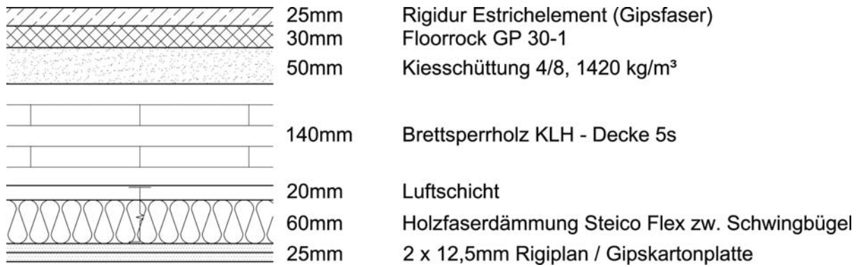
Abbildung 8-21: Aufbau der geprüften Geschossdecke
