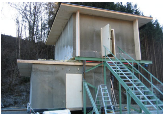
Bild 4. Hochflexibler Massivholz-Deckenprüfstand, errichtet im Rahmen des Schallschutzprojektes von KLH Massivholz GmbH Fig. 4. Highly flexible solid wood test facility, built by KLH Massivholz GmbH
