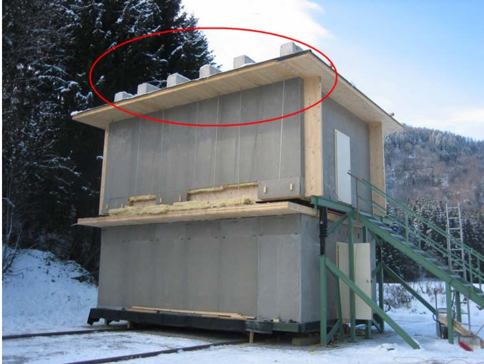
Abbildung 8-6: Mit Betonelementen (rote Markierung), Gesamtgewicht 240 kN, belasteter Deckenprüfstand
