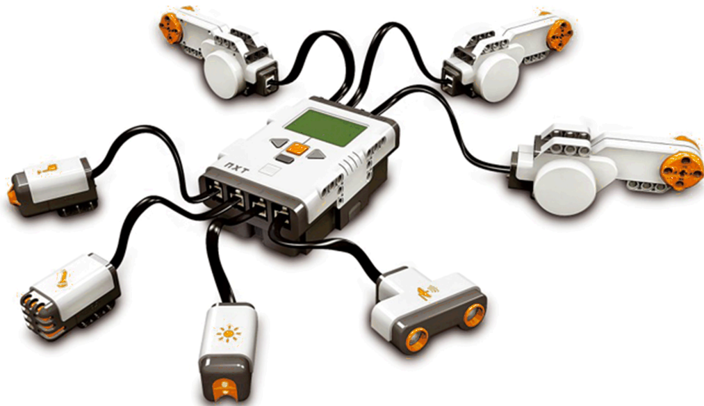
Abbildung 30: NXT-Stein mit Aktoren und Sensoren
