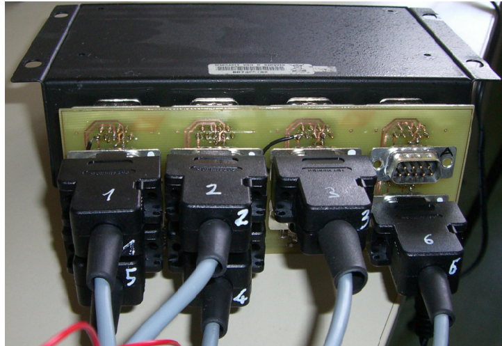
Abbildung B.3.: Messeinrichtung zur Abnahme der DSC-Daten samt Weitergabe an den PC
