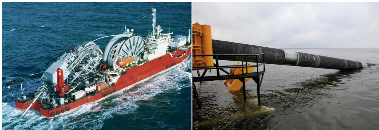
Abbildung 1-2: Offshore Verlegung von Pipelines: aufgerollte Pipelines auf dem Verlegungsschiff Apache 2 (links) [2]; auf dem Schiff geschweißte Pipelines bei der Auslegung (rechts) [3]
