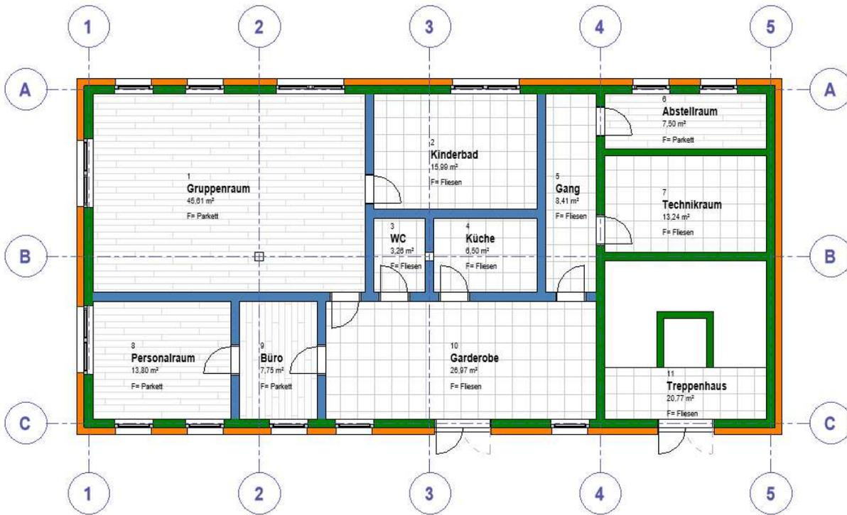
**Abb. 3.2: Grundriss EG (Grün = Stahlbetonwände; Blau = Gipskartonständerwände; Orange = Wärmedämmung)<sup>116</sup>**
