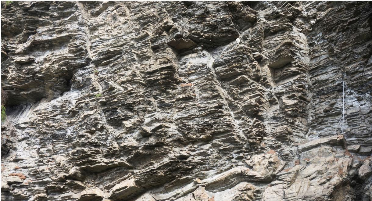
**Abb. 8.10:** Ausbiss im Arbeitsgebiet: An diesem und ähnlichen Ausbissen konnten mittels Outcrop-Mapping die geometrischen Eingangsparameter für das Discrete Fracture Network wie Kluftgröße und Kluftabstand ermittelt werden, Quelle: Wildbach- und Lawinenverbauung Tirol.
