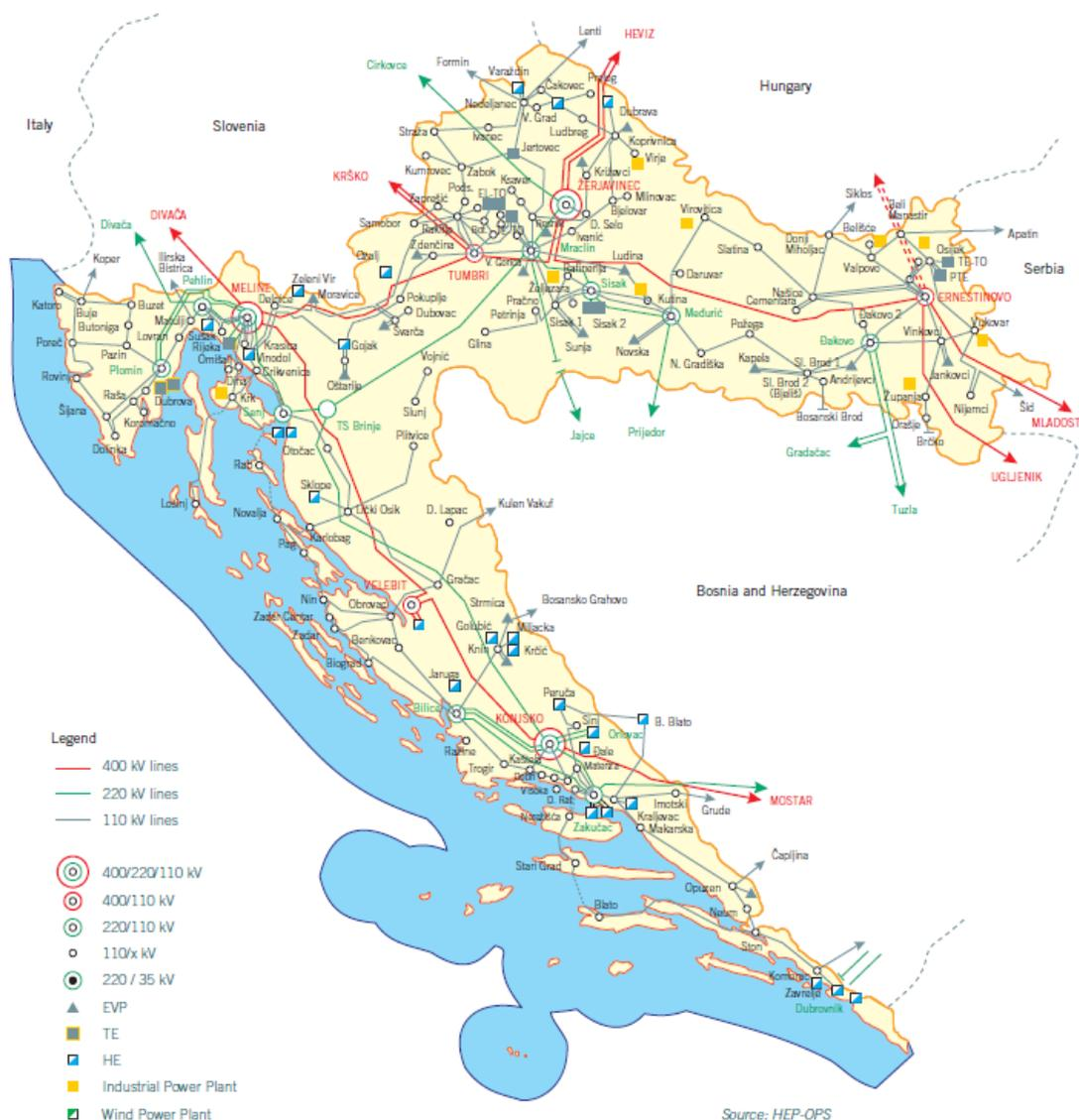
Abbildung 44: Stromübertragungsnetz in Kroatien, Stand 2009, Quelle: (hera 2009)
