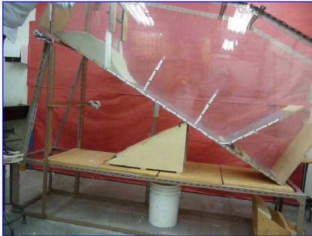
ABBILDUNG 16: DER VERSUCHSKANAL KURZ NACH DEM ÖFFNEN DES SCHIEBERS. MARKIERUNGEN IM ABSTAND VON 10CM ENTLANG DER STURZBAHN ERLEICHTERN DIE ANALYSE (MANCARELLA & HUNGR, 2010).
