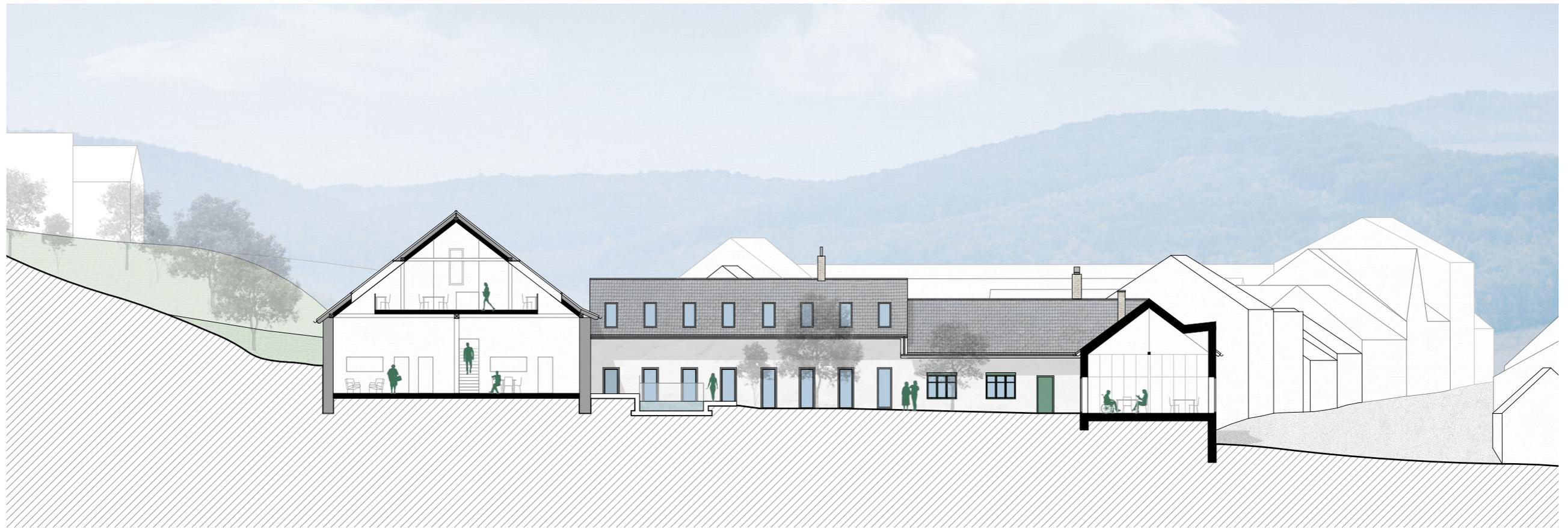
Schnittansicht durch die Scheune und den kleineren neuen Baukörper
