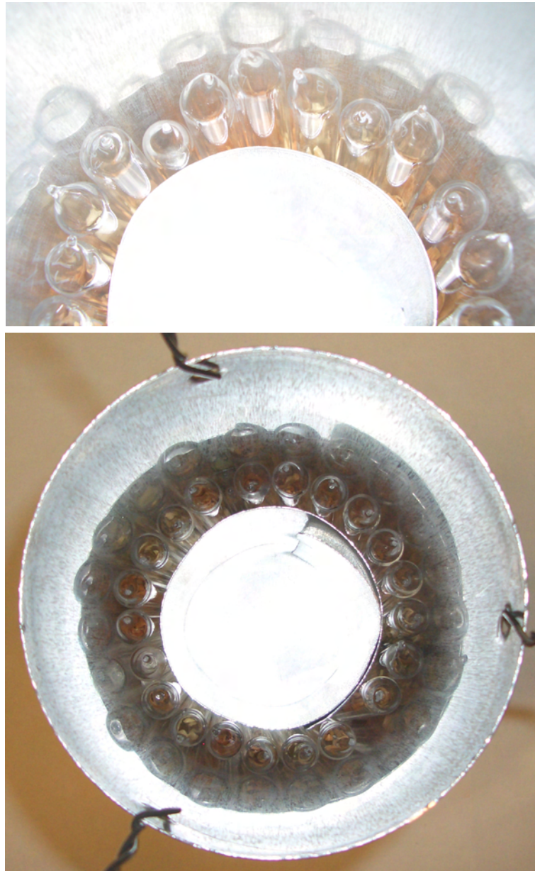
Abbildung 6.1.: rotierender Probenbehälter (oben Zentralperspektive, unten Aufsicht); Die Proben sind am inneren Umfang angeordnet, und werden durch eine Aluminiumfeder an den einschließenden Aluminiumbecher gedrückt. Angebrachtes Blei (fehlt in Fotos), verhindert das Aufschwimmen der einzelnen Proben. Der Aussendurchmesser des einfassenden Aluminiumbechers beträgt 100 mm.
