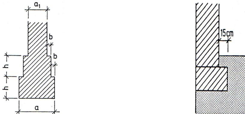
**Abbildung 1:** Streifenfundament allgemein [1, S. 142] **Abbildung 2:** Fundament an der Grundgrenze [1, S. 142]
