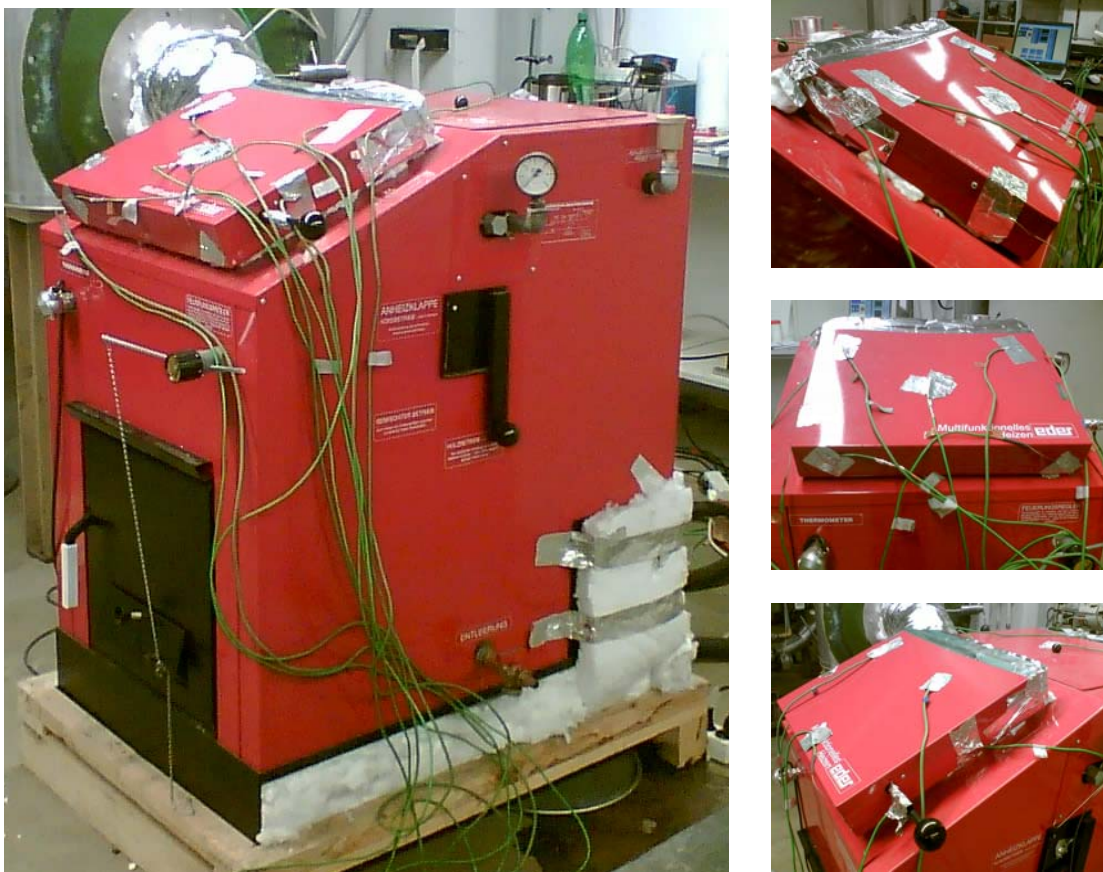
Abbildung 6-12: Messstellen für die Oberflächen-Thermoelemente an der Fülltüre des Kessels
