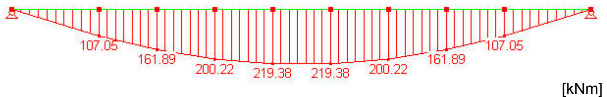
Abb. 81 Char. Momentenlinie der Querträger bei 3,5 m Querträgerabstand für den Ermüdungsnachweis FLS (Charakteristische Werte ohne \Phi_2 und \lambda )
