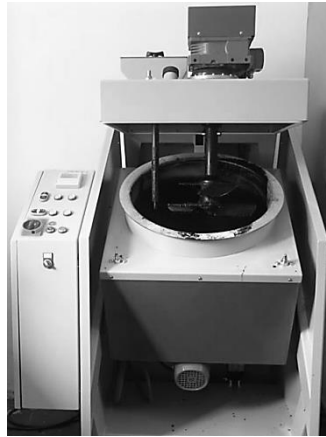
Abbildung 14: Labormischer mit Drehmomentaufnehmer
