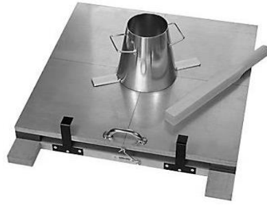
Abbildung 15: Prüfeinrichtung Ausbreitversuch (Quelle: ratioTEC)
