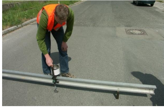
Abbildung 94: Querebenheitsmessung mit dem Planum
