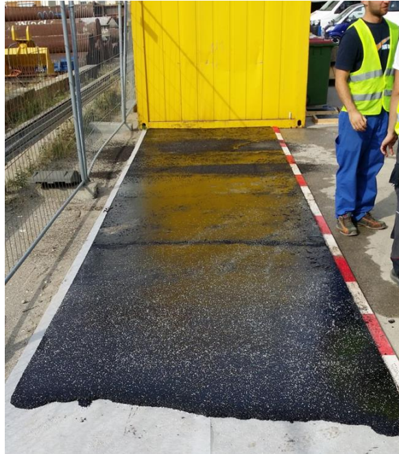
Abbildung 16: Probefeld zur Bestimmung der tatsächlichen Einbautemperatur der modifizierten Mischgüter
