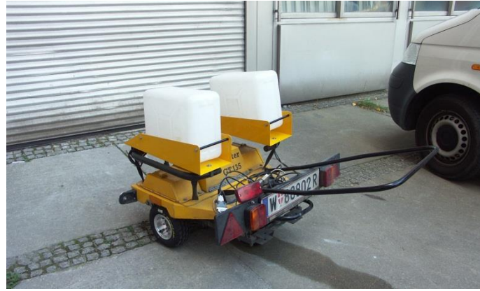
Abbildung 97: GripTester MK II (Labor TU Wien)
