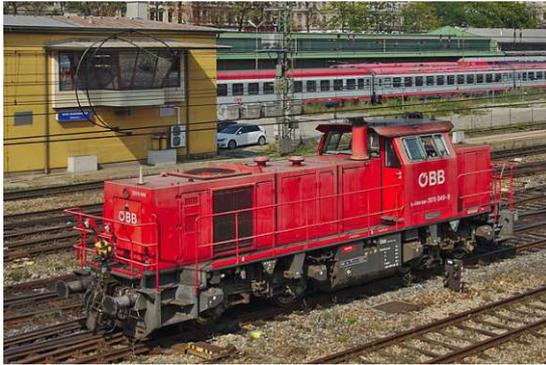
a) Dieselhydraulische Verschublokomotive
