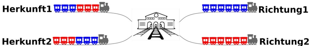
Abbildung 2.5: Schematische Darstellung der Aufgaben eines Verschiebebahnhofes: Zerlegung von Zügen und Aufbau von neuen Zügen
