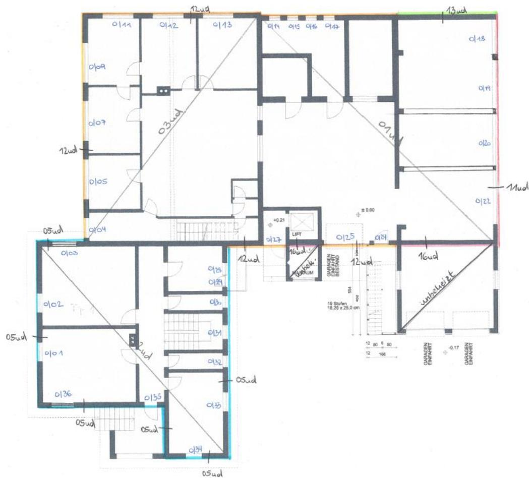
Abbildung 2-26 Bauteilkennzeichnung lt. PHPP – Erdgeschoss (Arbeitsskizze, ohne Maßstab)
