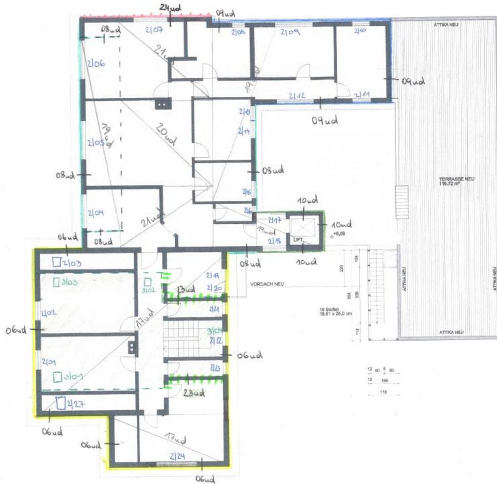
Abbildung 2-28 Bauteilkennzeichnung lt. PHPP – 2. und 3. Obergeschoss (3.OG grün hinterlegt; Arbeitsskizze, ohne Maßstab)
