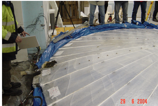
Abbildung 7.22: Beginn der Ausbildung einer Delle im Nahbereich der Spannstelle
