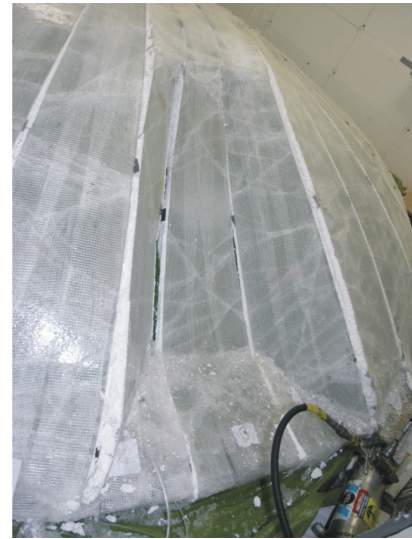
Abbildung 7.26: a) Rettungsversuch mittels Auflast; b) Eingedellter Bereich
