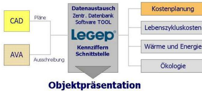
Abb. 5.2: Schema des Datenaustausches mit LEGEP<sup>109</sup>
