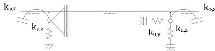
Abbildung 3.20.: Mechanische Modellbildung - Modell 7
