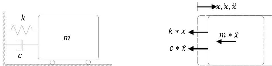
Abbildung 2.1: Einmassenschwinger
