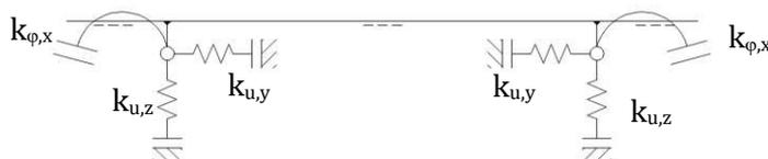
Abbildung 3.21.: Mechanische Modellbildung - Modell 8
