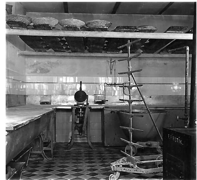
Abb. 36: Bäckerei Höttl, Maissau, Backtrog mit Arbeitstafel, Teigteilmachine und Wagen für Gärläden; 1932
