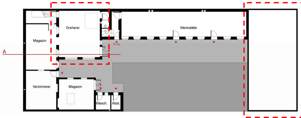
Abb. 41: Grundriss mit neuer Dreherei und Schuppen, der dunkelgraue Bereich markiert den neu angelegten Garten
