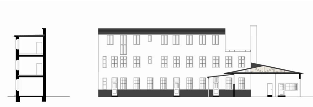
Abb. 65: Schnitt A durch den Längstrakt und Ansicht mit dem zweiten Stockaufbau
