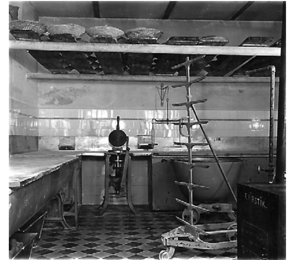
Abb. 74: Bäckerei Höttl, Maissau, Backtrog mit Arbeitstafel, Teigteilmaschine und Wagen für Gärläden; 1932
