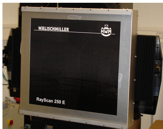
Abbildung 3.3: Bild (links) und schematischer Aufbau der Detektoreinheit (rechts), [rei09]
