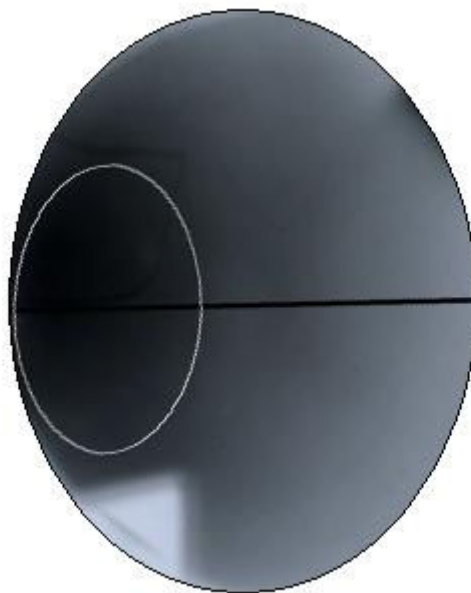
Abbildung 2.9: Filmaufnahme der Intensitätsverteilung des primären Röntgenstrahls in einem Röntgenspektrometer wie in Abbildung 2.8
