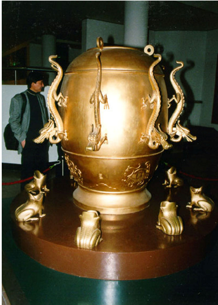
Abbildung 02: Modell des Seismoskops von Zhang Heng
