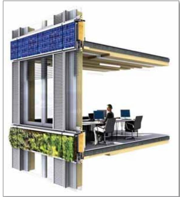
Abbildung 29, Fassadenschnitt Photovoltaikpaneel
