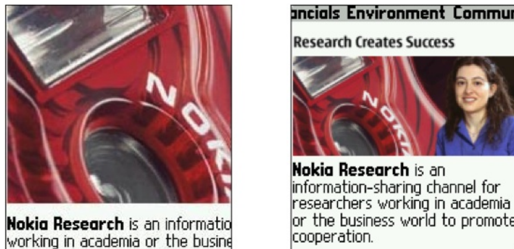
Abbildung 2.7: Links: originales Layout in mobilem Browser; Rechts: Minimap Skalierung [Popescu 06]
