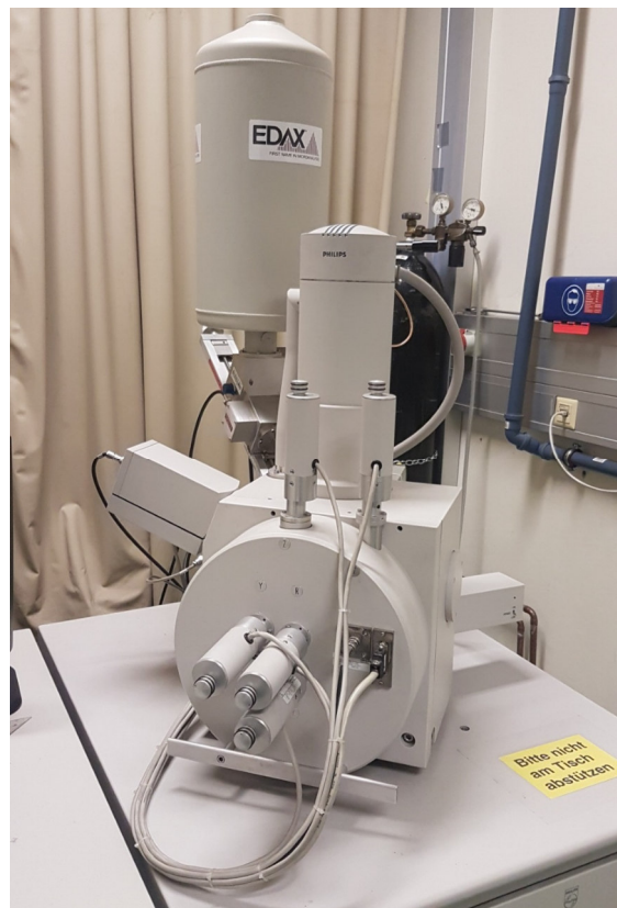
Abb. 24: Rasterelektronenmikroskop Philips XL-30 mit EDAX Einheit.
