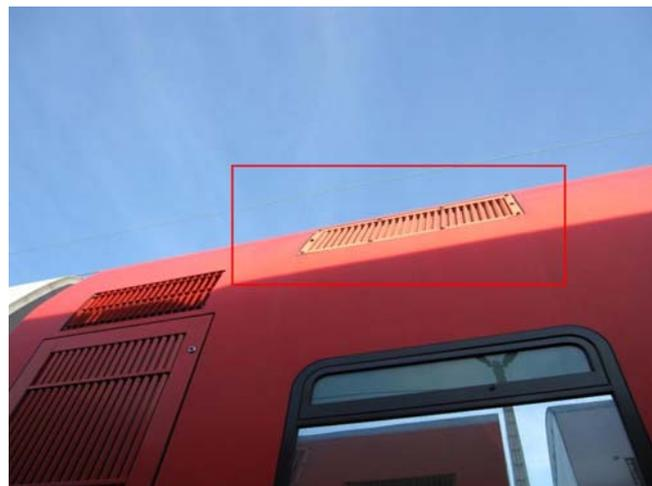
Abb. 19 Frischluftansaugung an der Außenseite eines Doppelstockwagens
