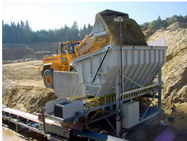
Abbildung 1: Anwendungsbeispiel eines Bunkers mit Abzugsband. Das un stetig ankommende Schüttgut wird vom Bunker stetig weitergeben. [13]
