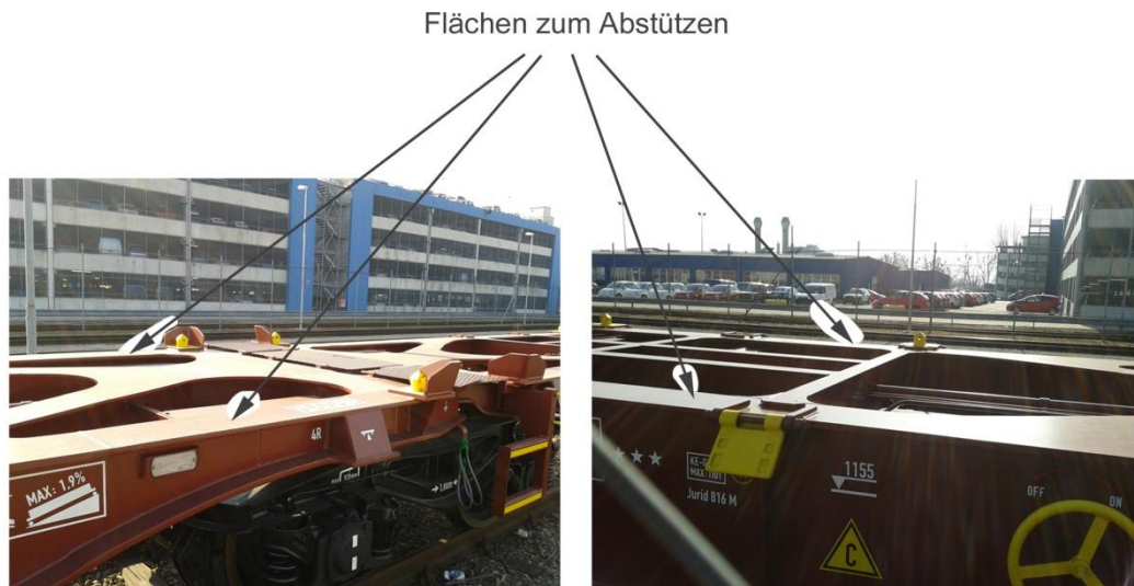
Abbildung 30: Flächen zum Abstützen am Waggon
