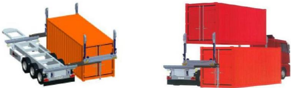
Abbildung 2: A) Aufnehmen vom/Abstellen am Boden – B) Container übereinander stapeln
