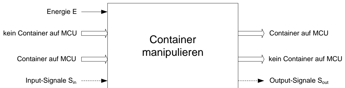
Abbildung 13: Gesamtfunktion des mobilen Container-Umsetzers
