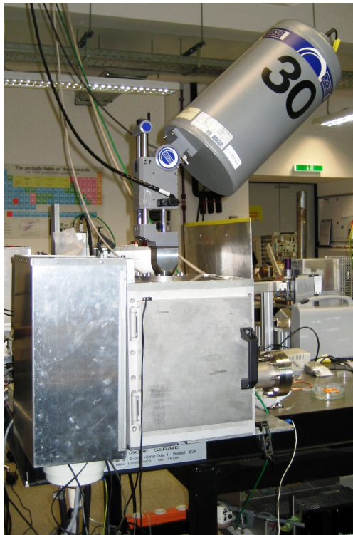
Abbildung 6.1: Außenansicht der ATI Low Z TXRF Kammer
