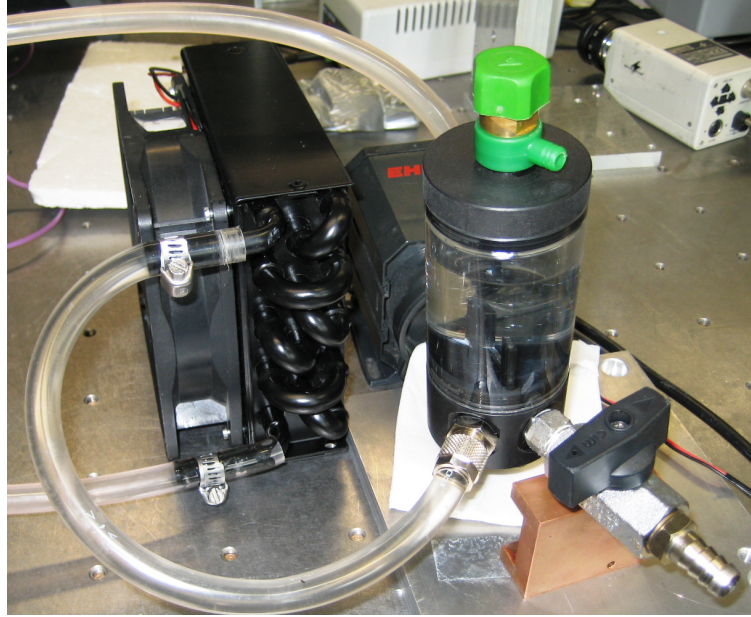
Abbildung 9.4: Die im Aufbau verwendete Pumpe und der Radiator
