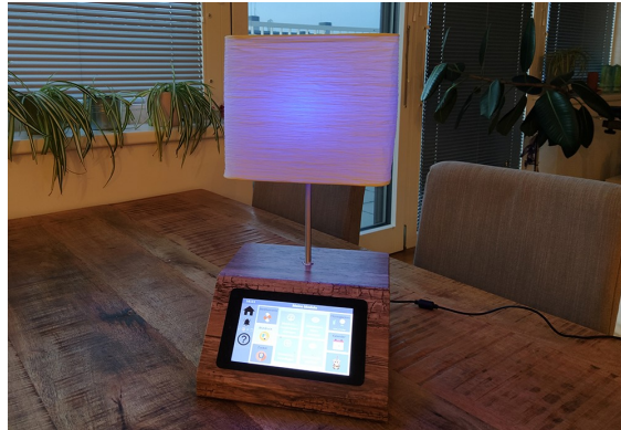
(a) Sobald eine Erinnerung aktiviert wurde, beginnt die Lampe zu leuchten und die konfigurierte Ton-datei wird abgespielt.
