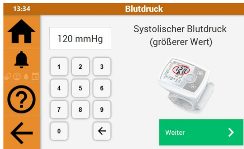
Abb. 4.56: Über ein Zahlenfeld wird der gemessene Wert eingegeben, wobei eine Grafik zeigt, wo der jeweilige Wert normalerweise abgelesen werden kann.
