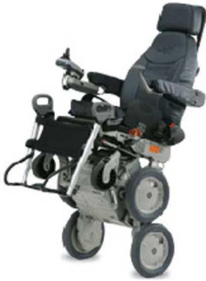
Abb. 2.17: Der iBOT kann sich mithilfe der selbst-stabilisierenden Funktion auf Augenhöhe erheben. [109]
