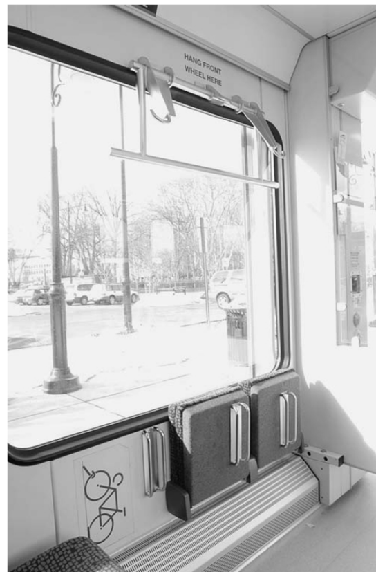
Abbildung 10: Multifunktionales Abteil mit vertikaler Sicherung in New Jersey (Modell: Stadler „GTW 2/6 DMU“) Quelle: TCRP, 2005, S.28
