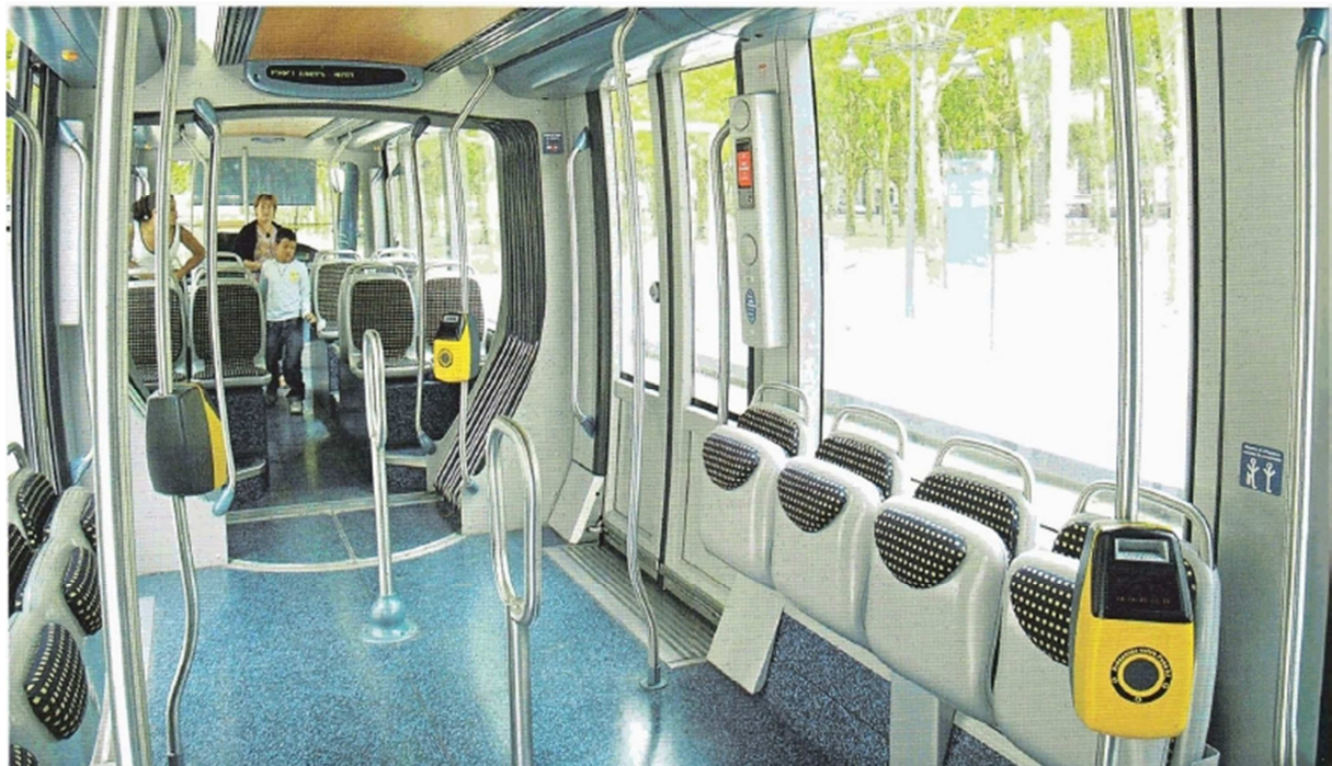
Abbildung 6: Multifunktionsraum innerhalb der Straßenbahn mit freier Fahrradsicherung in Bordeaux (Modell Alstom Citadis „402“) Quelle: JAHN, 2010, S.100
