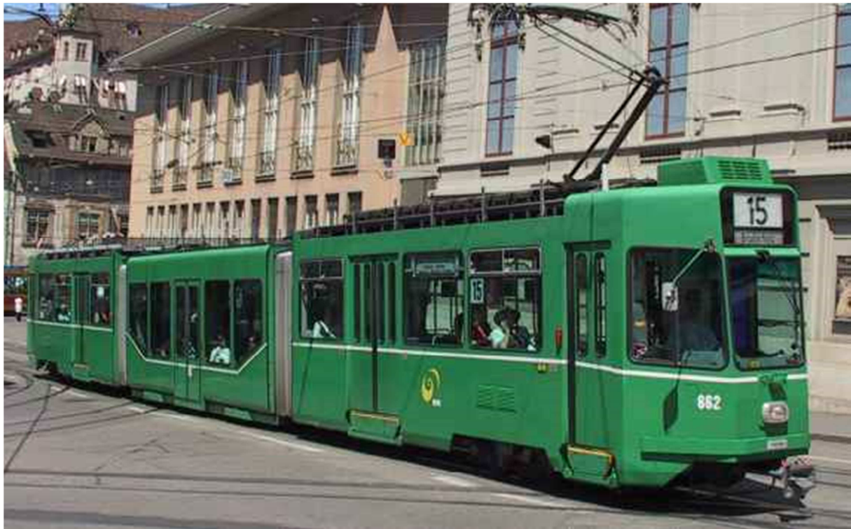
Abbildung 5: Niederflur-Mittelteil (SWS „Be 4/6 Sänfte“) in Basel (BVB) Quelle: ZIEGLER, 2003
