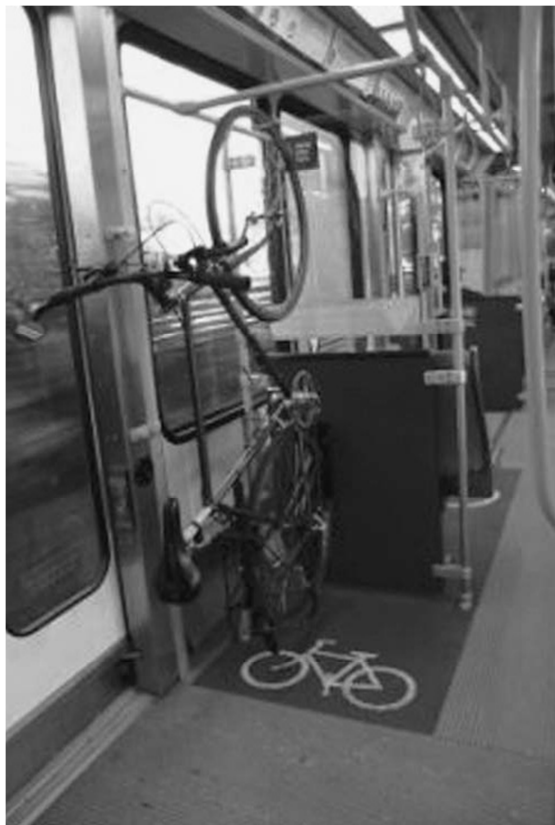
Abbildung 9: Vertikale Sicherung des Rades in Portland (Modell: Skoda „10T“) Quelle: TCRP, 2005, S.30
