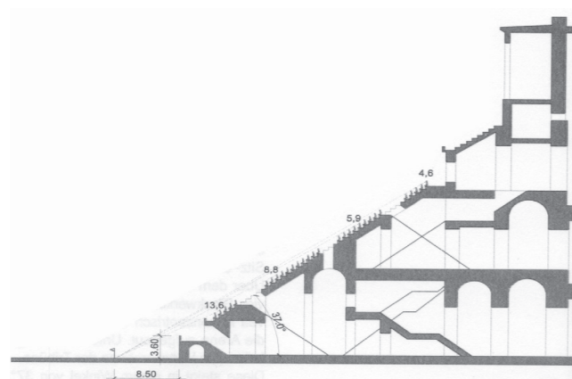
2.23 Schnitt durch das Kolosseum Rom
