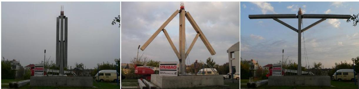
Abbildung 9: Feldversuch Druckstrebenvariante – Klappvorgang<sup>1,18</sup>
