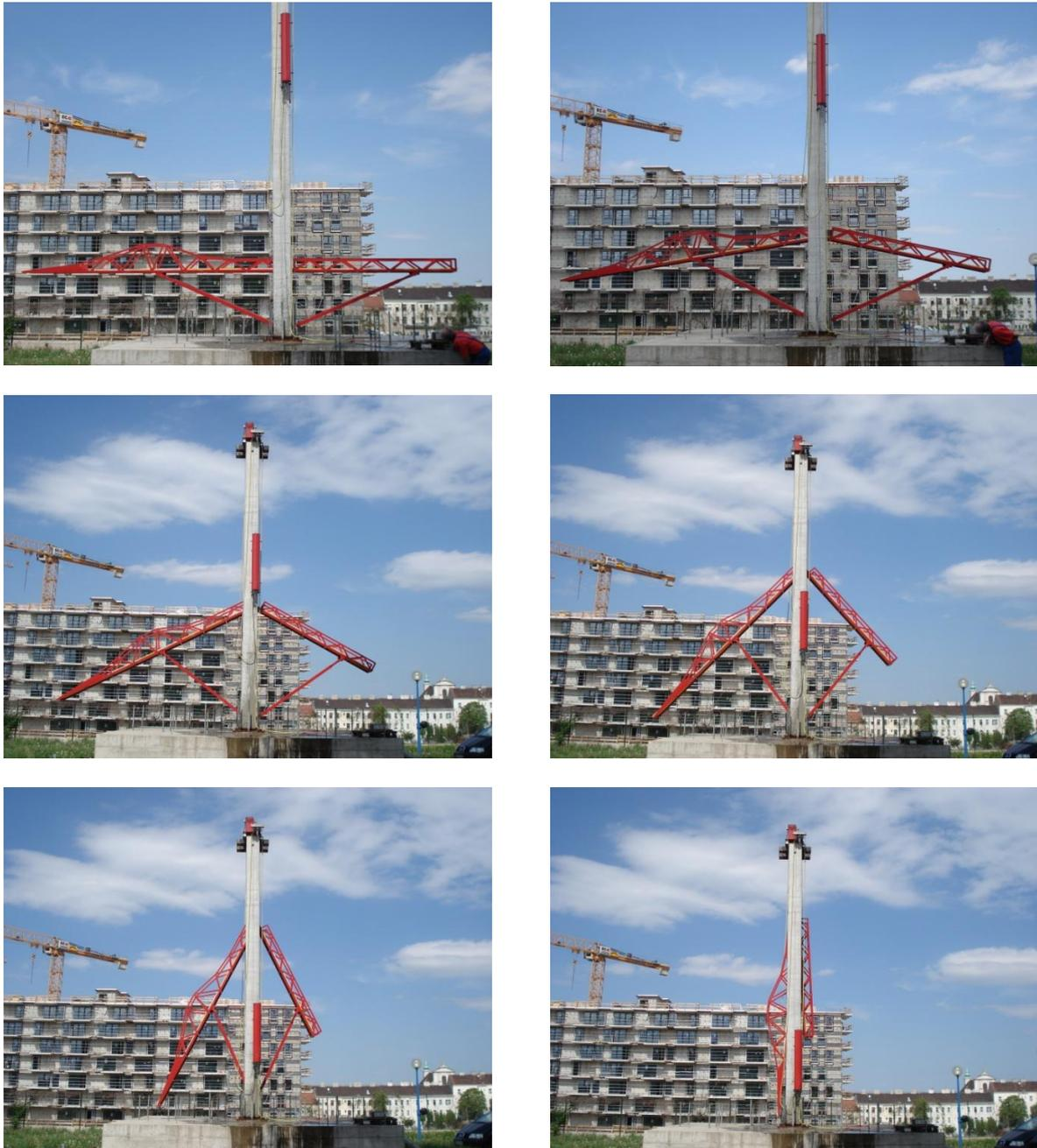
Abbildung 17: Klappvorgang beim Feldversuch Klappbrücke Lobau
