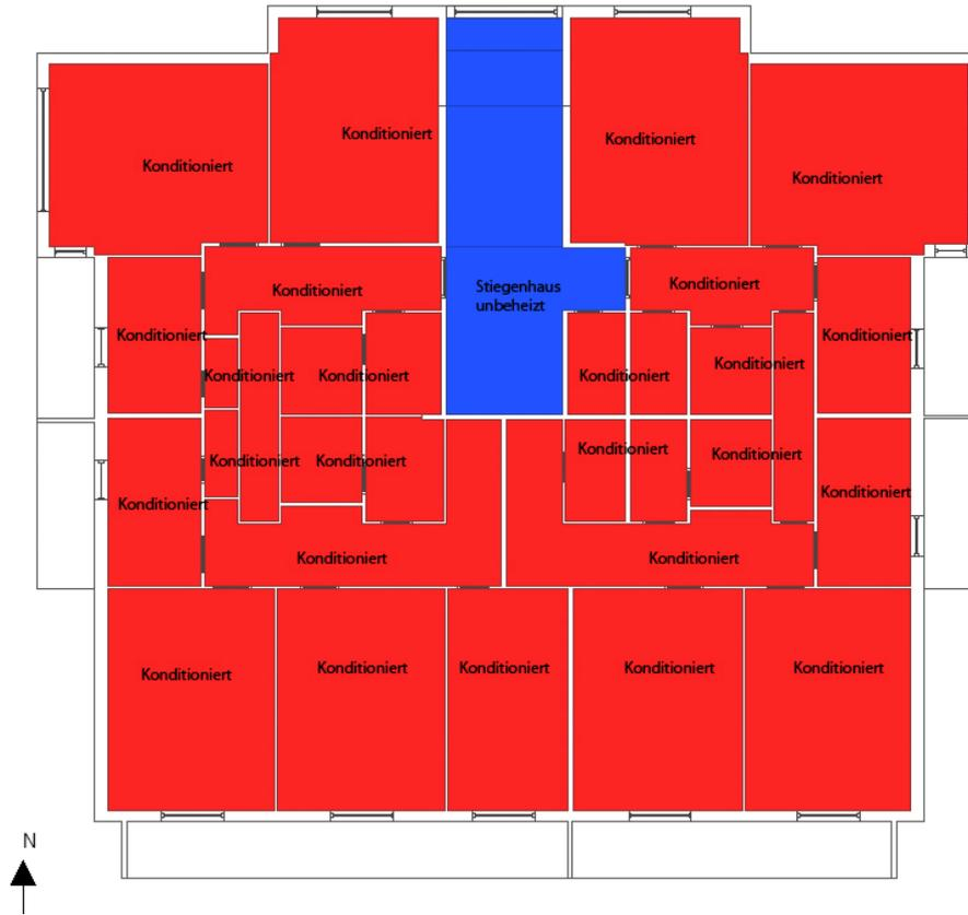
Abbildung 2.4. - Grundriss des Regelgeschosses O1 (eA)
