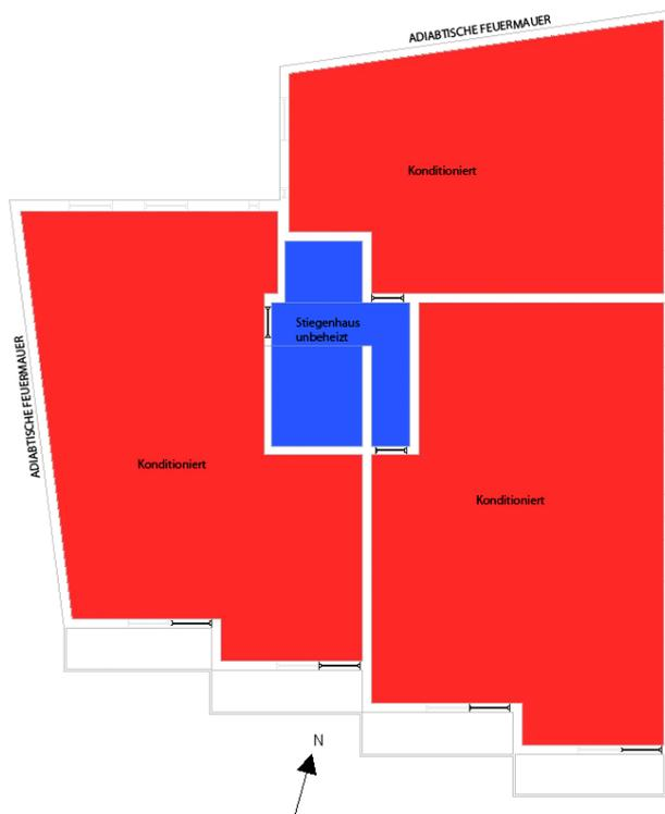
Abbildung 2.24. - Grundriss Regelgeschoss O6 (eA)
