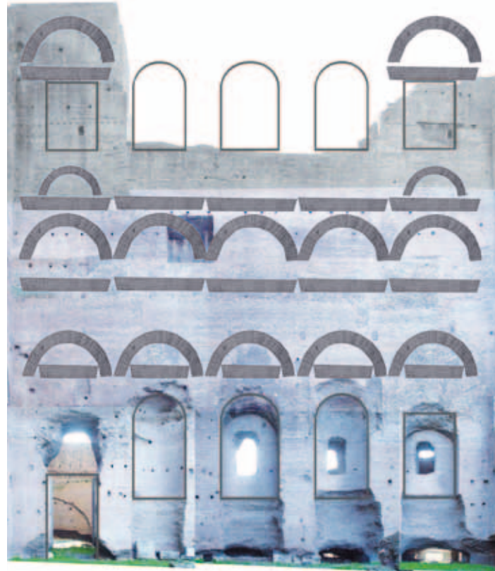
Abb. 7/80 Schematische Darstellung der fehlenden oder beschädigten Gestaltungselemente der Südwand und die entsprechenden Entlastungsbögen.
