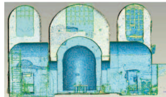
Abb. 5/39 Digitaler Längsschnitt durch das Mittelschiff und das Presbyterium der spätantiken Kirche Santa Maria Antiqua (Punktwolke), 2004.
