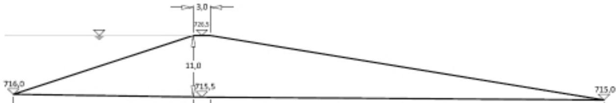
Abbildung 82: Prinzipskizze des überströmbaren Dammquerschnitts
