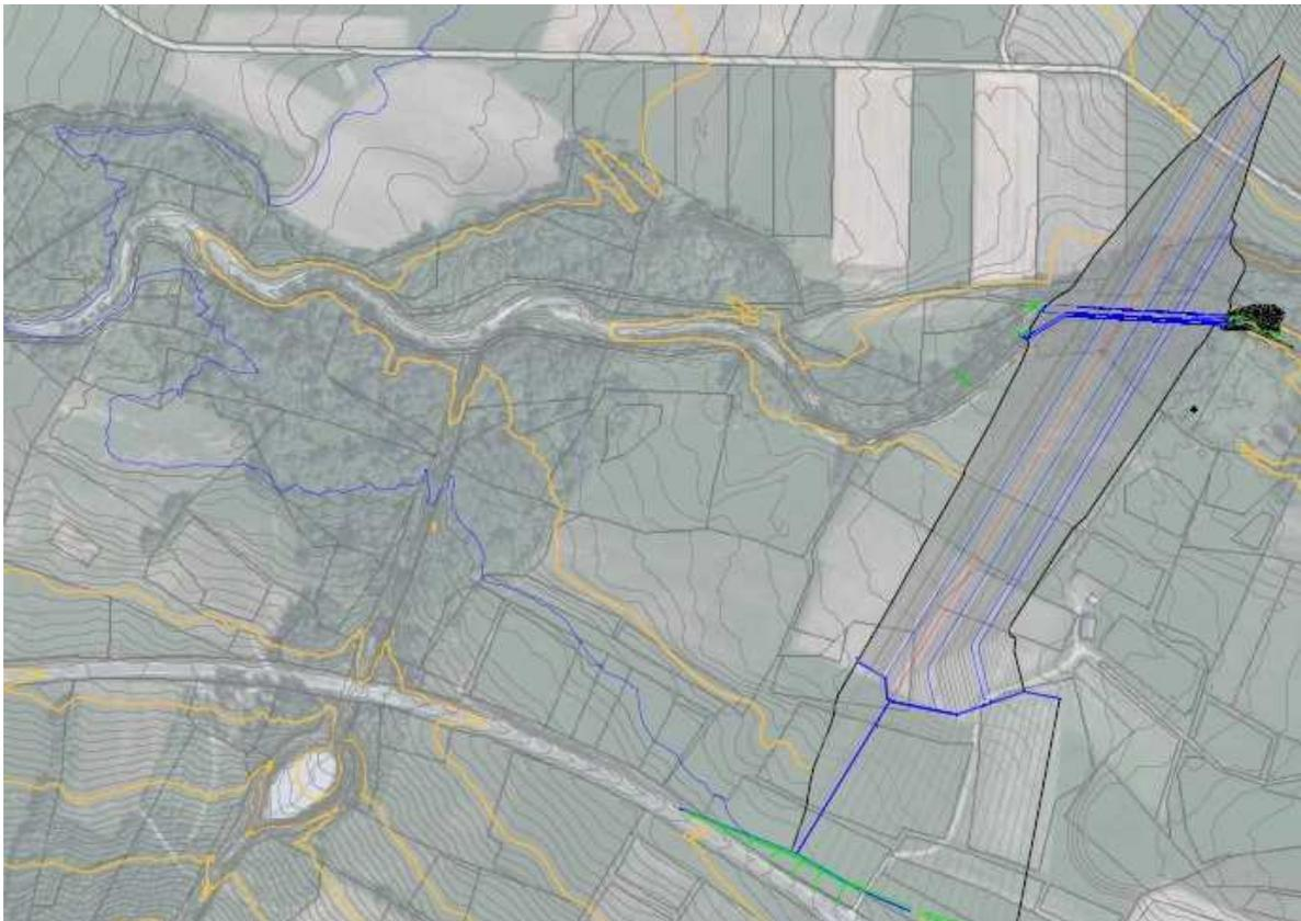
Abbildung 78: Entwurf eines klassischen Erddamms mit einer Böschungsneigung von 1:3 am selben Standort
