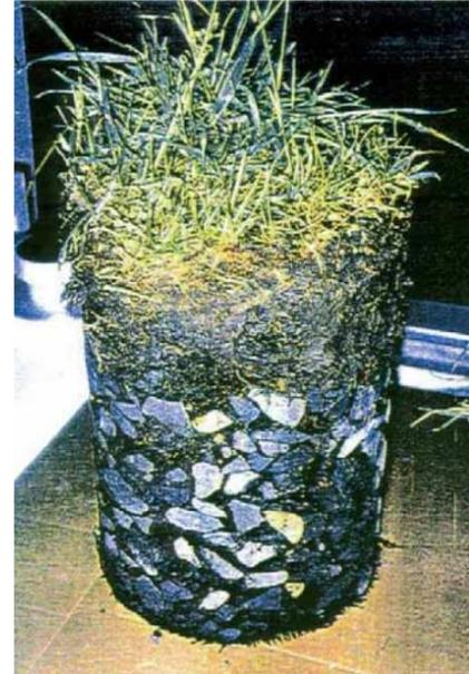
Abbildung 83: Querschnitt begrüntes Mastix-Schotter-Deckwerk<sup>227</sup>
