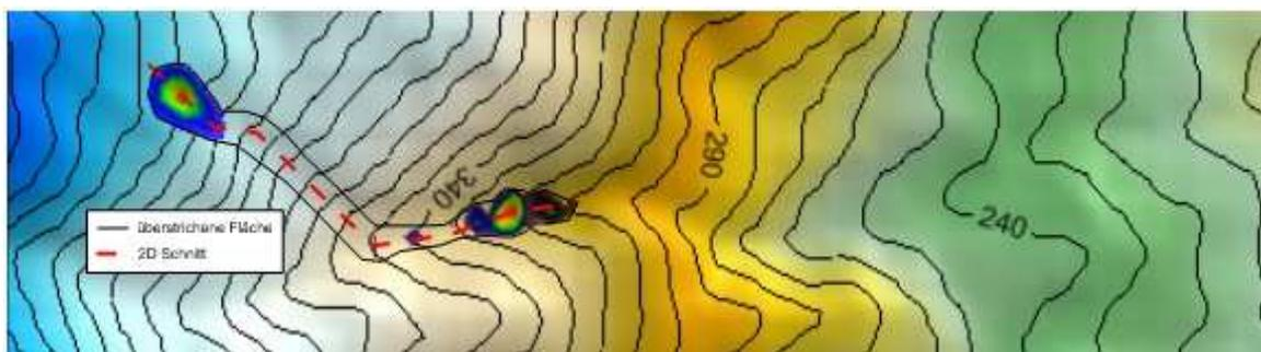
Abb. 45: Ausgangs- und Endlage der Bates Cairn Mure (Abbruch)
