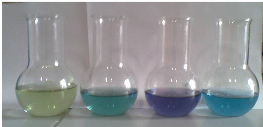
Abb. 3-5: Farbumschlag Titration, v.l.n.r.: Abwasser – gelb, Abwasser - grün/türkis, Trinkwasser – blau, Trinkwasser – cyan<sup>2</sup>
