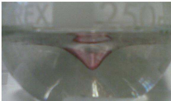
Abb. 3-8: Erste Farbänderung im Trichter bei 96,3% des Verbrauchs an EDTA
