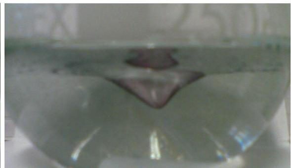
Abb. 3-9: Leichter Violetteinschlag im Trichter noch erkennbar bei 99,5% Verbrauch EDTA
