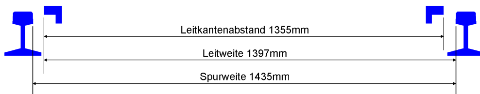
Abb. 9 – Gleismaße Weichenbereich Vollbahn
