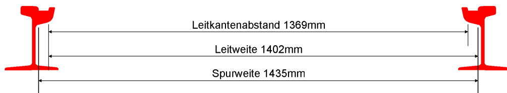
Abb. 11 – Gleismaße Weichenbereich Straßenbahn (Flachrille)
