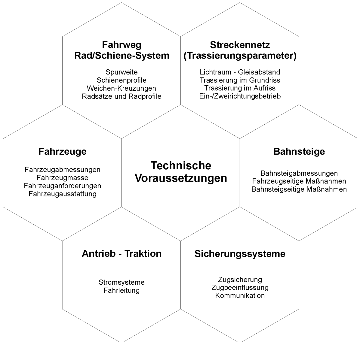
Abb. 3 – Übersicht technische Voraussetzungen
