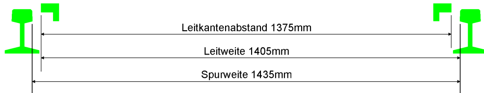
Abb. 10 – Gleismaße Weichenbereich U-Bahn
