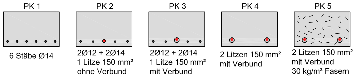
Abbildung 4.8: Querschnitte der Prüfkörper in Feldmitte
