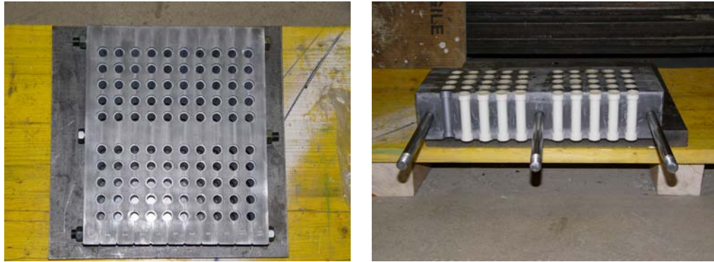
Abbildung 3.11: Schalung für die Verstärkungselemente des Typs 1
