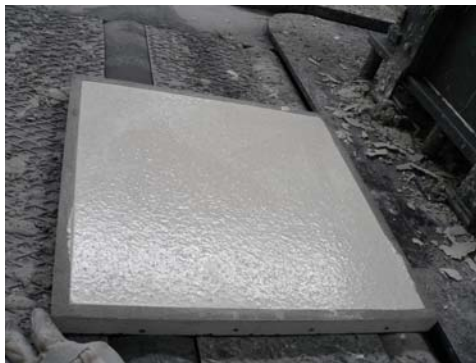
Abbildung 3.16: Schalung für die Verstärkungselemente des Typs 3
