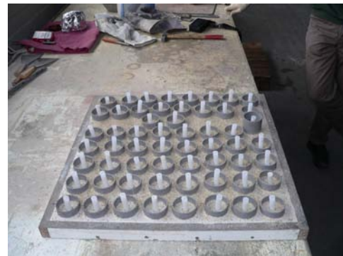
Abbildung 3.16: Schalung für die Verstärkungselemente des Typs 3
