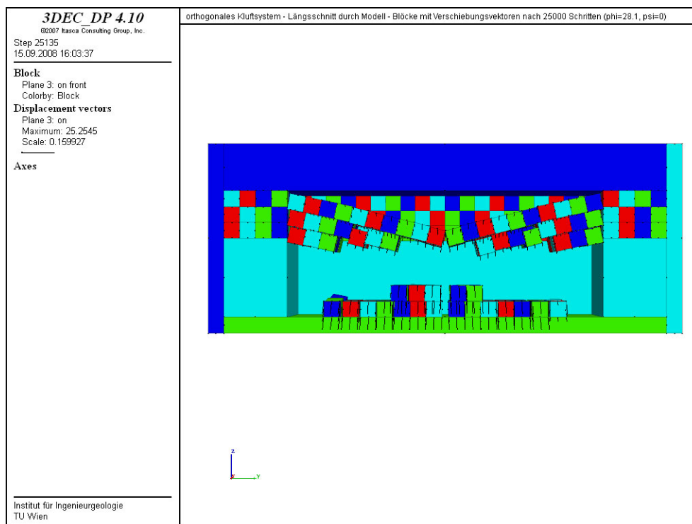
Abbildung 4.14: Längsschnitt durch das Modell – Lage der Blöcke inkl. Verschiebungsvektoren nach 25000 Rechenschritten für \varphi = 28.1^\circ und \psi = 0^\circ
