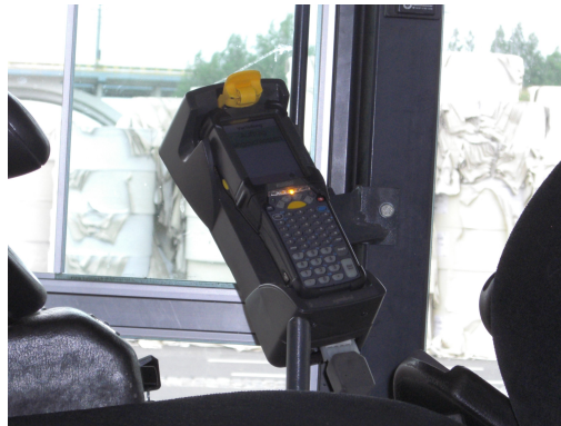
Abbildung 1.3: Foto eines Lesegeräts in einem Stapler.
