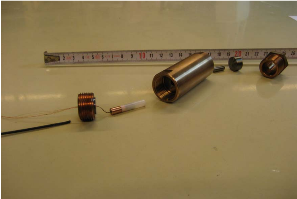
Abbildung 3.2: Probenhalterung: hier sieht man links den Anfang des Konus
