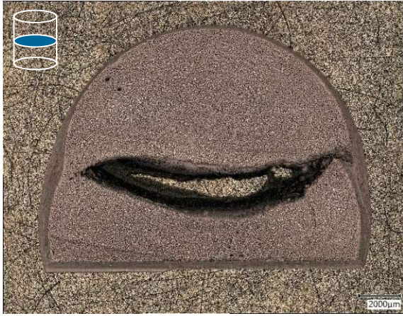
Abbildung 28: Lichtmikroskopische Panoramaaufnahmen von unpolierten Schnittflächen der Probe AIN_u_TBA_20v%_5K_4. Links: xy-Ebene. Rechts: xz-Ebene.
