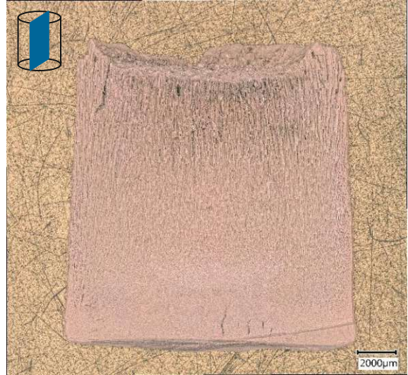
Abbildung 28: Lichtmikroskopische Panoramaaufnahmen von unpolierten Schnittflächen der Probe AIN_u_TBA_20v%_5K_4. Links: xy-Ebene. Rechts: xz-Ebene.
