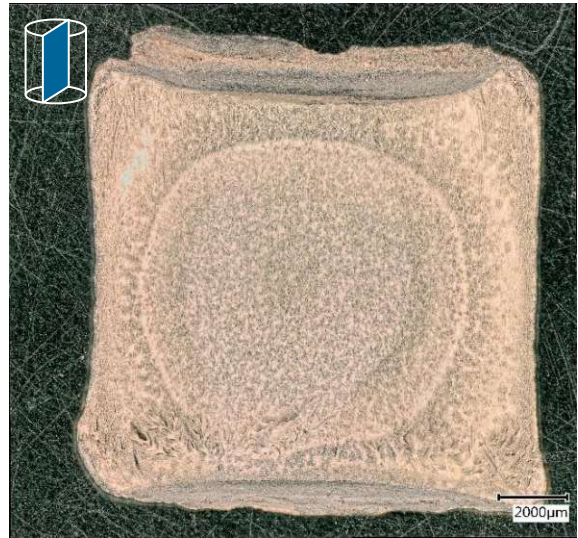
Abbildung 29: Lichtmikroskopische Panoramaaufnahmen von unpolierten Schnittflächen der Probe AIN_g_TBA70-H2O30_20v%_5K_4. Links: xy-Ebene. Rechts: xz-Ebene.
