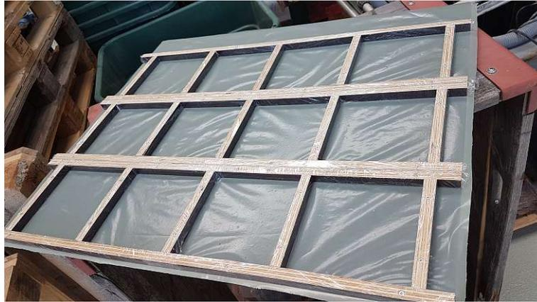
**Abb. 4.6:** Fertige Schalung aus Siebdruckplatte für 12 Probekörper
