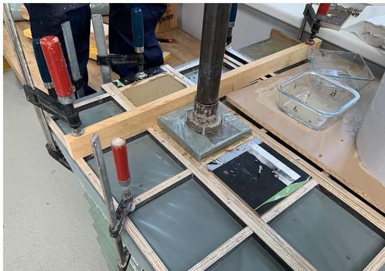
Abb. 4.3: Verdichtung: Lastverteilerplatte mit Zentriereinheit; Fallgewicht unten
