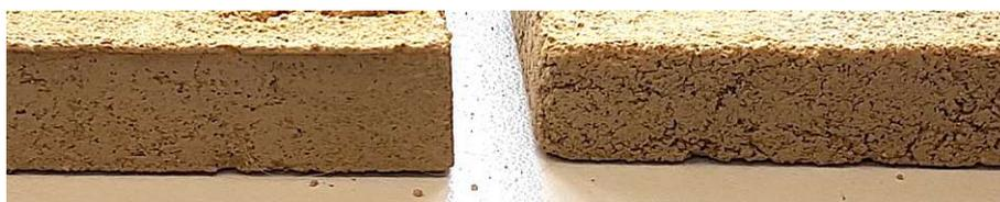
**Abb. 4.5:** Seitenansicht: Probekörper dynamisch (links) und statisch (rechts) verdichtet
