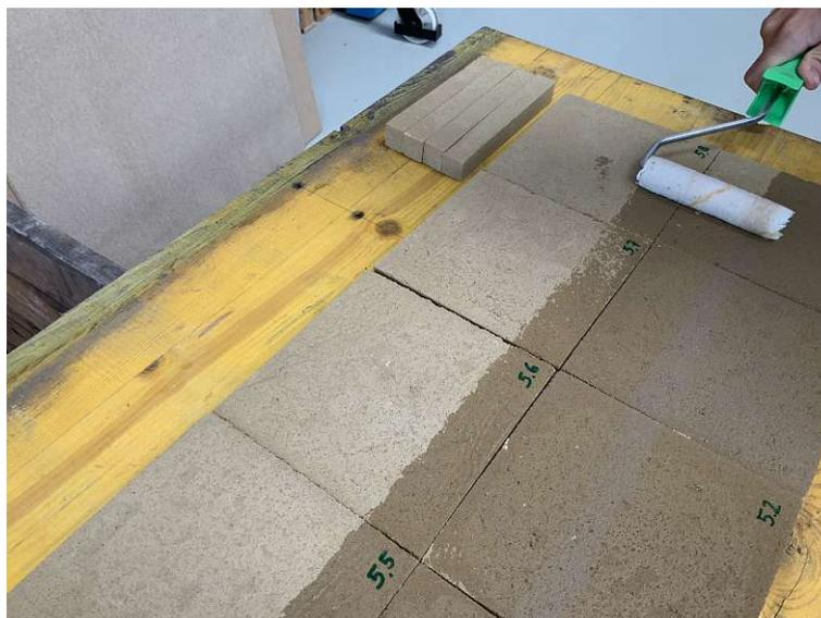
Abb. 4.16: Probekörper mit Carnaubawachsbeschichtung
