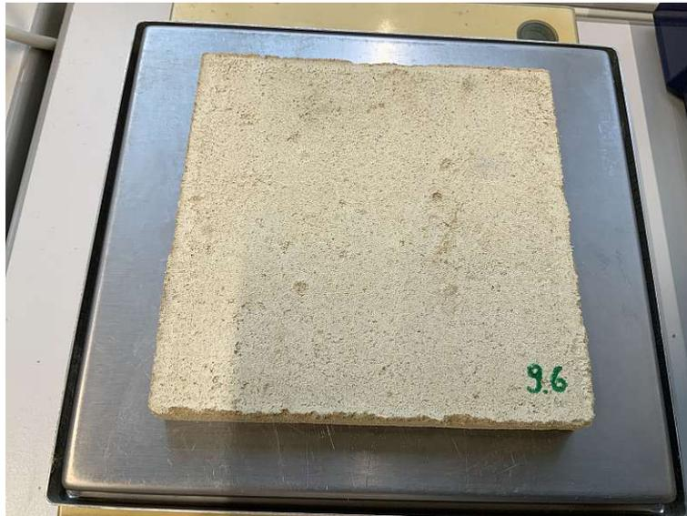
Abb. 4.11: Probekörper mit 4 Ma% Kalk gelöscht
