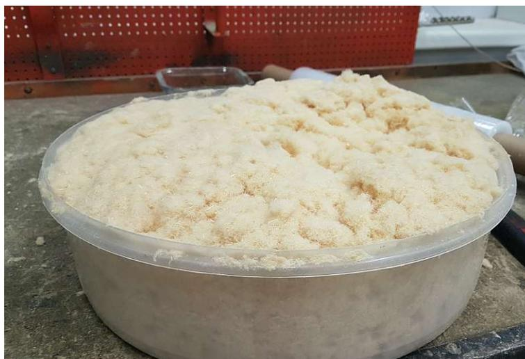
**Abb. 4.13:** Mittels Druckluft gelöste Holzfasern
