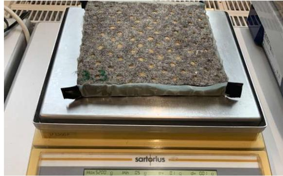
Abb. 4.21: Versiegelter Probekörper
