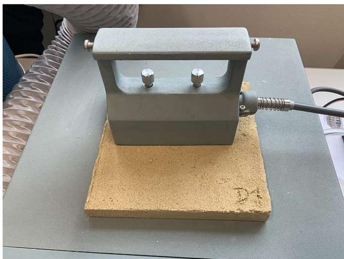
Abb. 4.19: Prüfsonde PD-13 auf Lehmkörper
