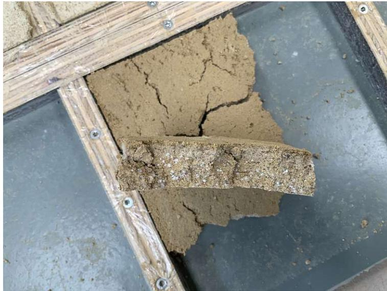
**Abb. 4.10:** Schimmelbildung im Probekörper mit 5 Ma% Kasein
