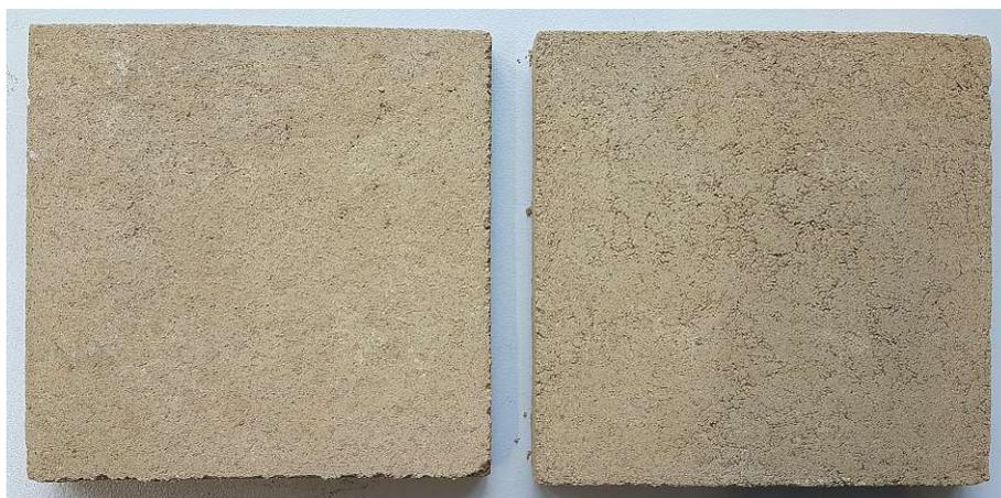
**Abb. 4.4:** Probekörper dynamisch (links) und statisch (rechts) verdichtet
