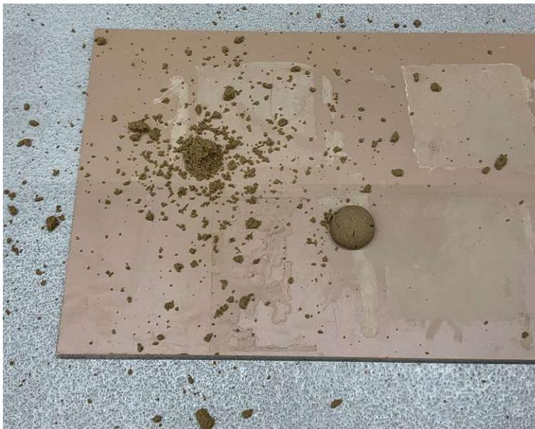
**Abb. 4.1:** Mischung ohne TLP (links), optimierte Mischung mit 5 Ma% TLP (rechts)
