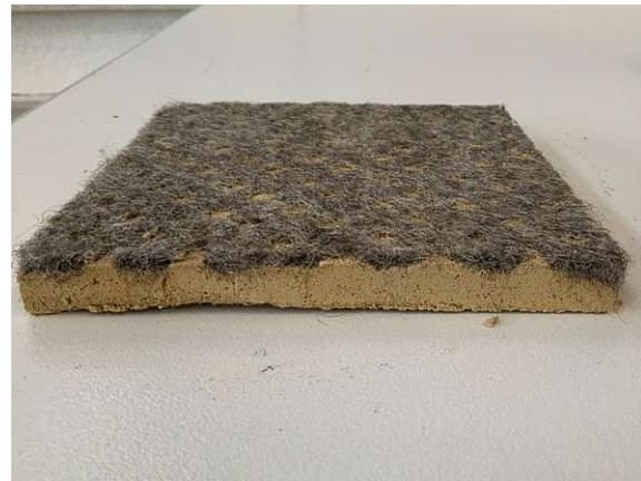
Abb. 4.9: Probekörper mit gelochtem Filz
