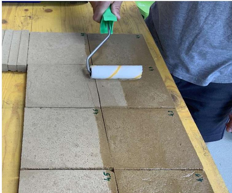
Abb. 4.15: Probekörper mit Wasserglasbeschichtung
