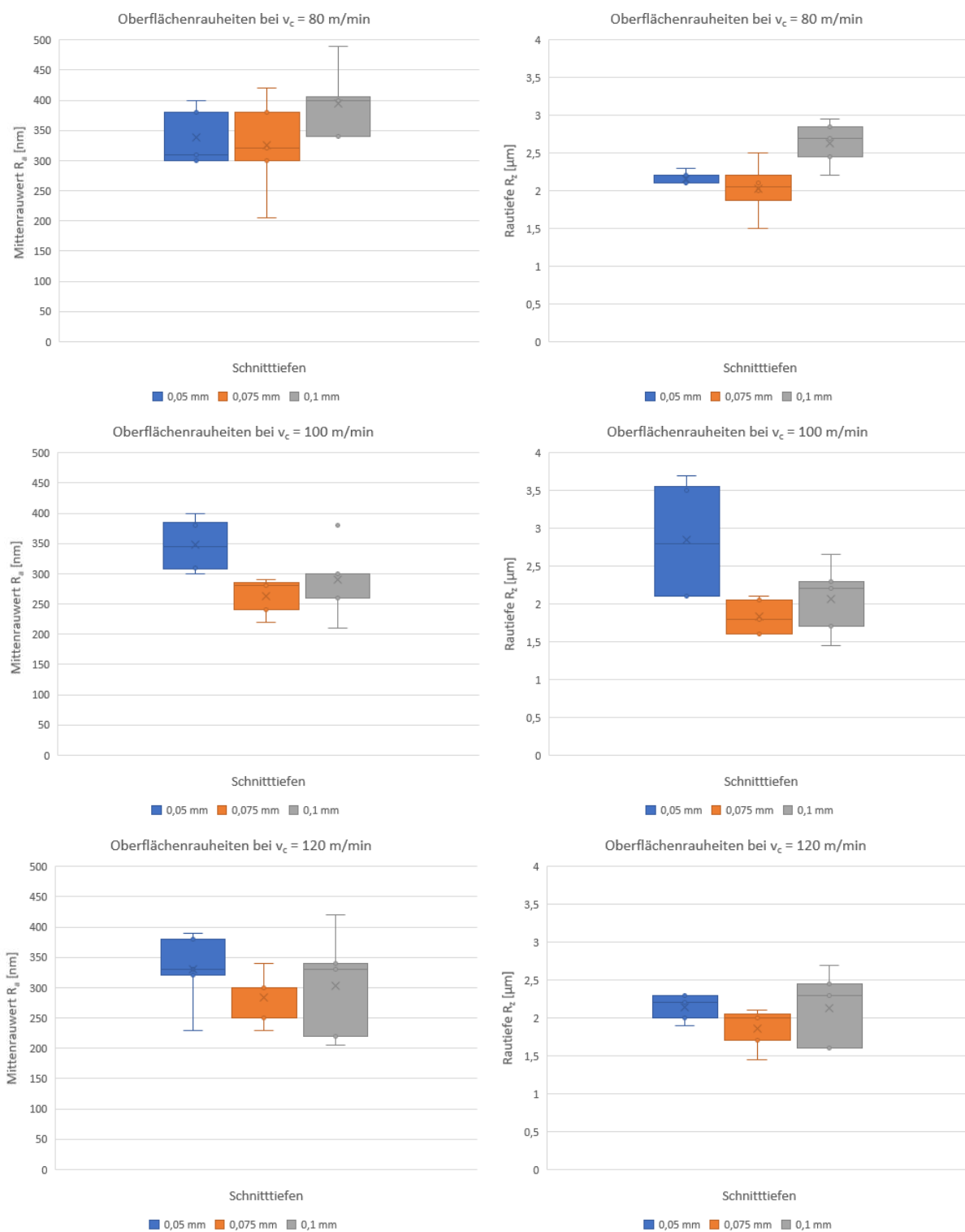
Abbildung 50: Gegenüberstellung aller Mittenrauwerte R_a und Rautiefen R_z der drei Schnitttiefen für die Schnittgeschwindigkeiten des Versuchsplanes
