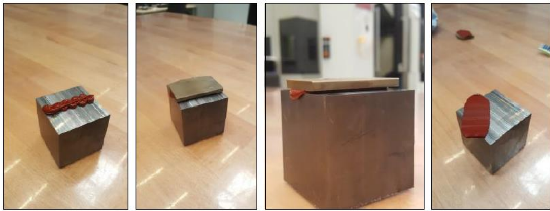
1. Auftragen der Masse 2. Gewicht zur Beschwerung 3. Gleichmäßige Verteilung der Masse 4. Fertig Abgeformtes Stück
