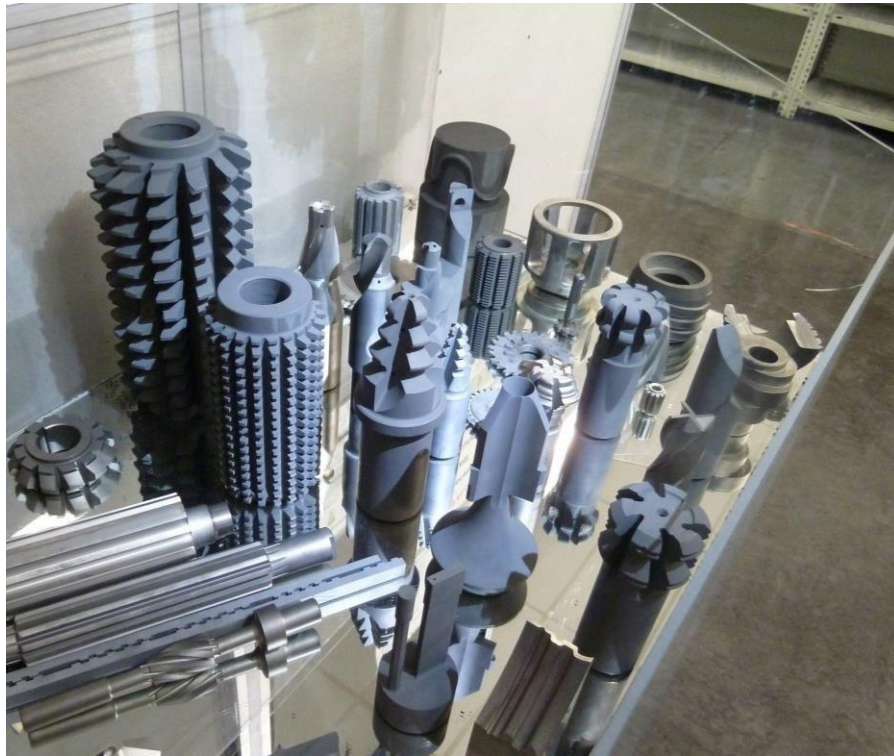
Abbildung 11: Verschiedene Grundformen von Hartmetallgrünlingen [19]
