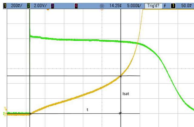
Abbildung 4.2: Messung des Sättigungsstromes der in Serie geschalteten Drosseln  $[xy]$ . Angelegte Spannung (grün) 10V. Die Drossel beginnt bei ca. 500mA (gelb) zu sättigen.
