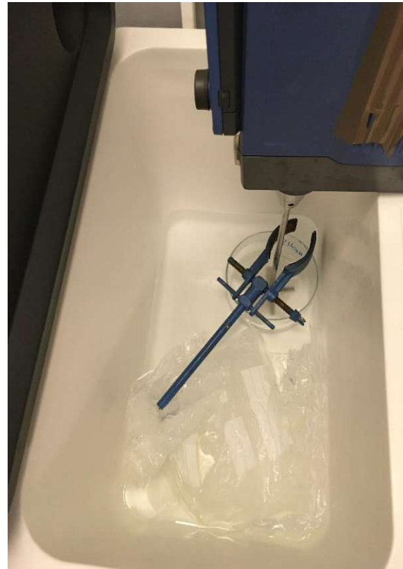
Abbildung 8: Aufbau der gekühlten Rührvorrichtung
