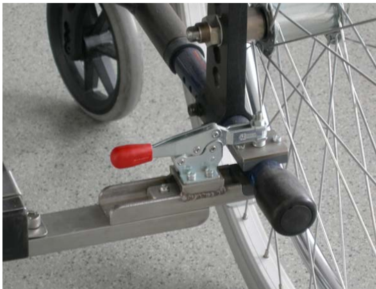
Abbildung 4.9: Klemme geschlossen. Die Anpassung an verschiedene Rohrdurchmesser ist durch verschiedene Unterlegscheiben an der Klemmbacke möglich.
