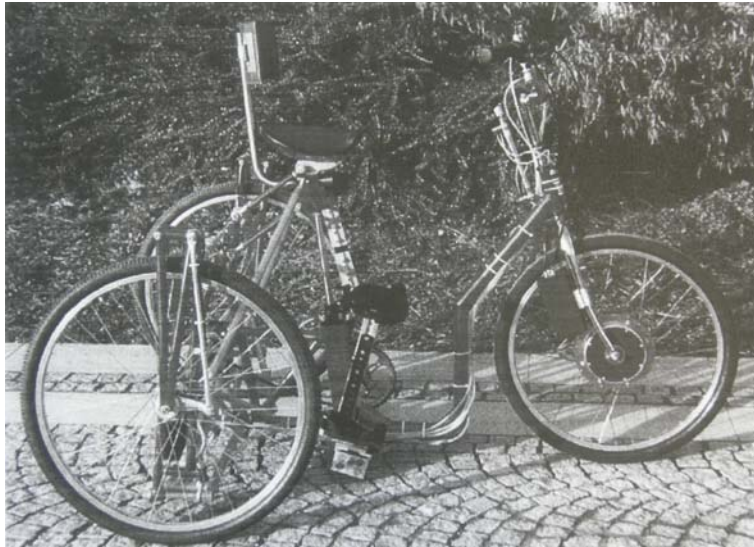
Abbildung 1.1: Das erste Trainingsfahrrad an der TU Wien [8] mit zwei neigbaren Hinterrädern und Nabenmotor im Vorderrad.
