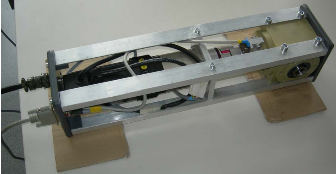
Abbildung 4.3: Die Antriebseinheit ohne Abdeckbleche. Gut zu erkennen sind der Rahmen und die Anschlüsse des Datenkabels und des Leistungskabels an der links liegenden Endplatte.
