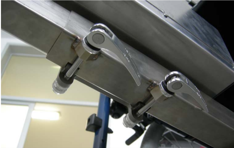
Abbildung 4.6: Der Längenverstellmechanismus von unten. Es wurde eine Auszugsicherung angebracht, sodass man die Teleskoprohre nicht unbeabsichtigt vollständig auseinanderziehen kann.
