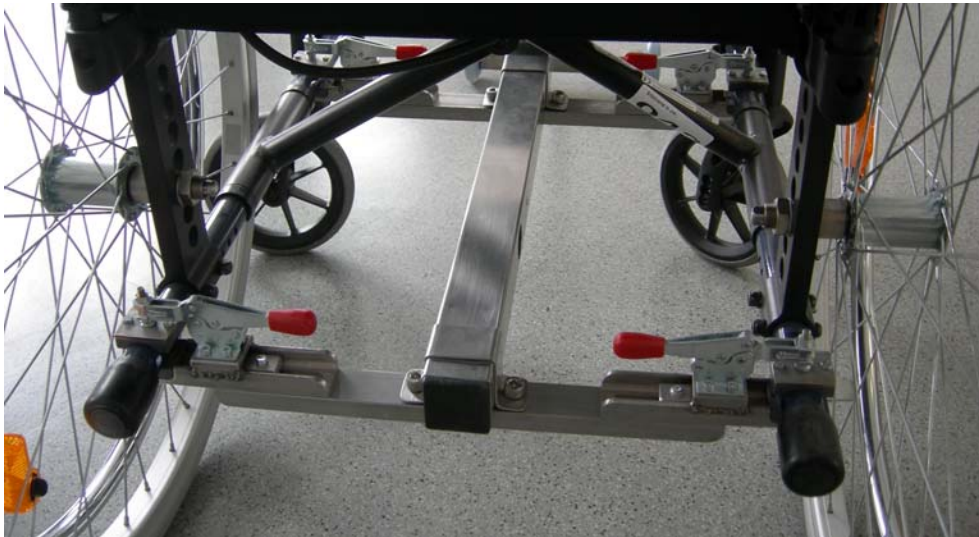
Abbildung 4.7: Der Halterungsrahmen von hinten. Längs läuft das Rohr der Längenverstellung und quer die beiden Querträger mit den Schnellspannzangen.
