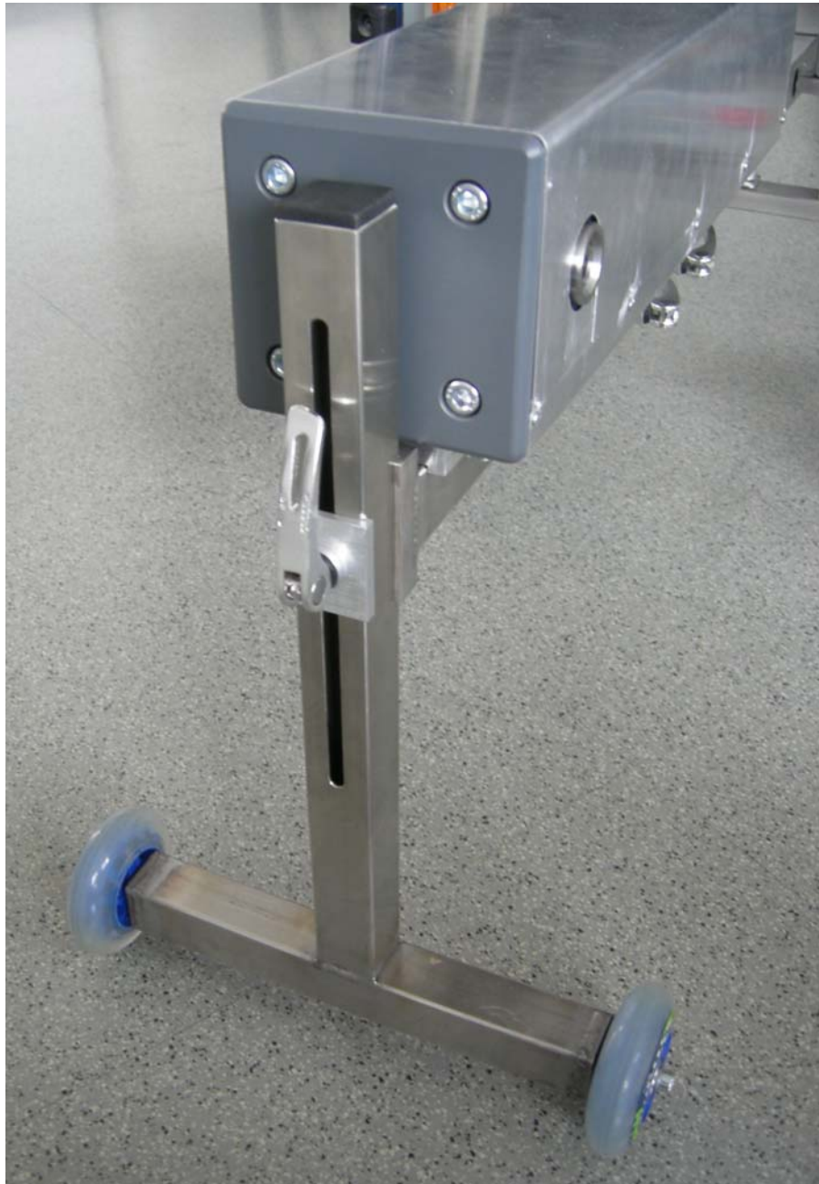
Abbildung 4.5: Der stufenlos verstellbare Ständer an der Vorderseite der Halterung. Weil die Rahmenrohre des Rollstuhls nie genau waagrecht verlaufen ist auch bei einer Längenverstellung die Ständerhöhe anzupassen.
