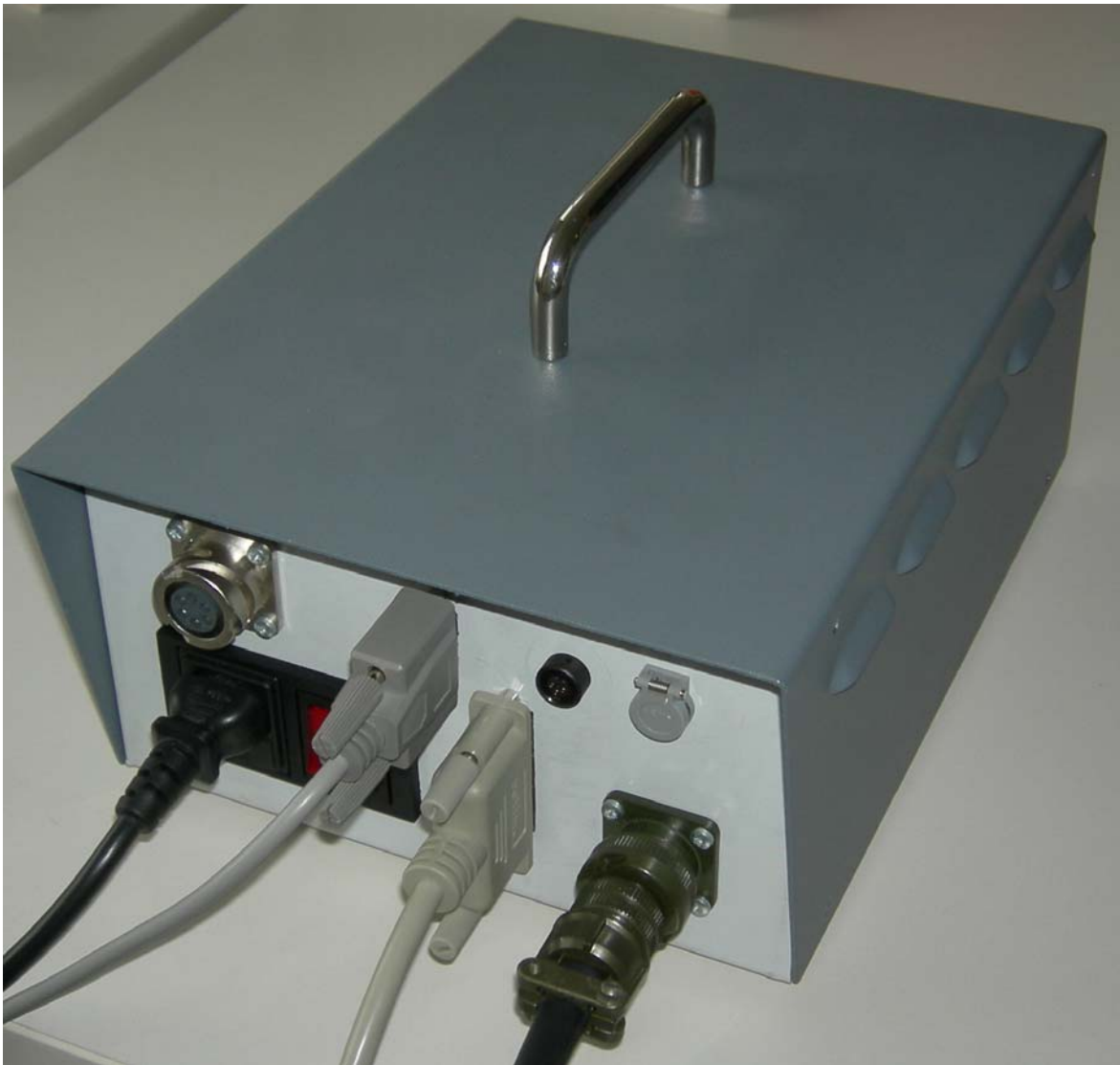
Abbildung 4.10: Die Steuerungsbox. Die Anschlüsse an der Vorderseite sind in der oberen Reihe für: Not-Aus-Schalter, Serielle Schnittstelle, Stimulation-Handregler, Stimulatorschnittstelle. In der unteren für: Stromversorgung (mit Schalter und Sicherung), Motor-Datenkabel, Motor-Leistungskabel.
